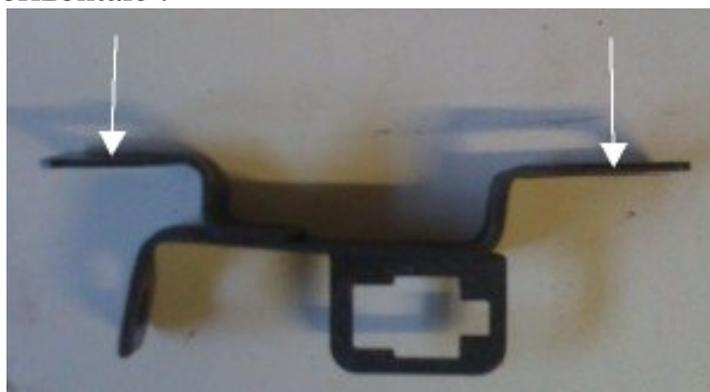
J'ai fixé la pompe sur le support en intercalant une rondelle en caoutchouc entre les pattes de la pompe et le support (pour servir de silentbloc).
